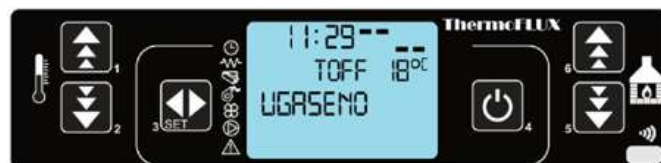
Prikaz displeja regulacije kotla Pelling u ugašenom stanju, (kotlovska temp.) Prikaz 1
